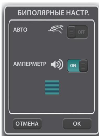
3. Прикоснитесь к кнопке **ОК**, чтобы закрыть окно настроек амперметра и сохранить внесенные изменения. Виртуальный амперметр добавляется к экрану биполярного режима, и во время работы в этом режиме обеспечивается звуковая и визуальная обратная связь.
