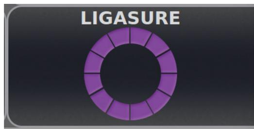
При включении инструмента на панели управления дисплея LigaSure загорается круговой индикатор выполнения операции; во время подачи энергии подается звуковой сигнал.
