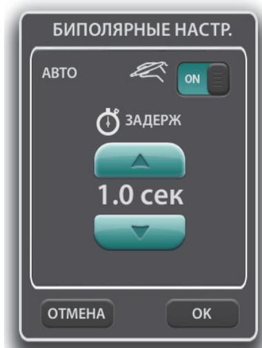
3. Прикоснитесь к кнопке **ОК**, чтобы закрыть окно и сохранить настройку времени задержки. Если задана задержка более 0,0 секунды, время задержки будет отображаться в области биполярного режима.
