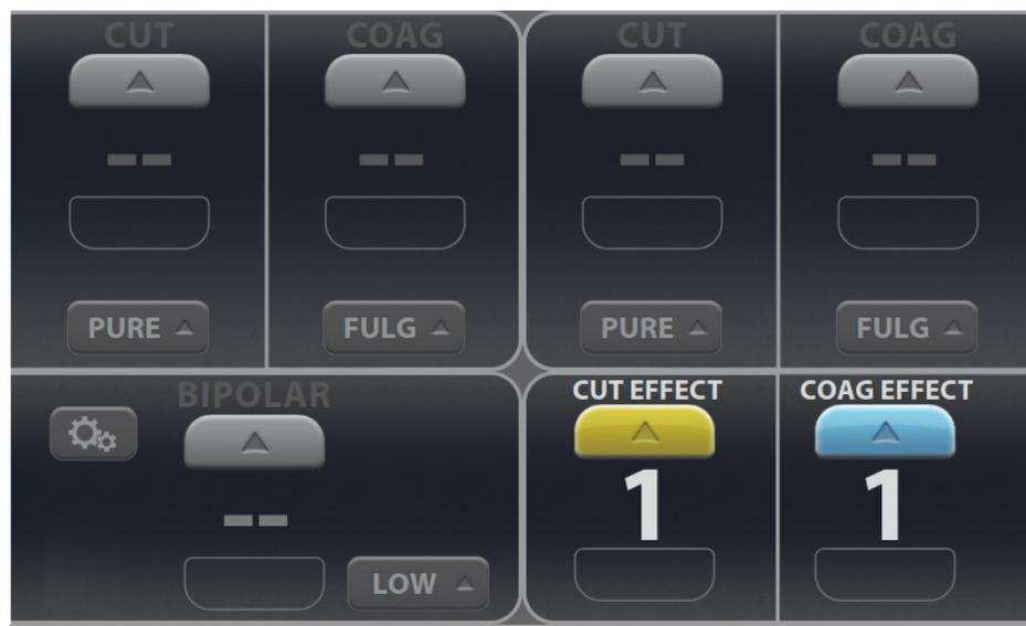
На экране биполярной резекции имеются элементы управления режимами CUT (Рассечение) и COAG (Коагуляция). Настройки уровня воздействия для каждого режима можно устанавливать в диапазоне от 1 до 6, при этом значение «1» соответствует минимальному уровню воздействия для выбранного режима. При включении инструмента экран биполярной резекции становится ярким: желтым — в режиме CUT (Рассечение) и синим — в режиме COAG (Коагуляция). Во время подачи энергии подается звуковой сигнал.
